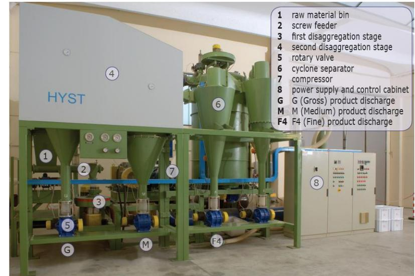
Impianto pilota HYST della capacità di 1-5 t/h
